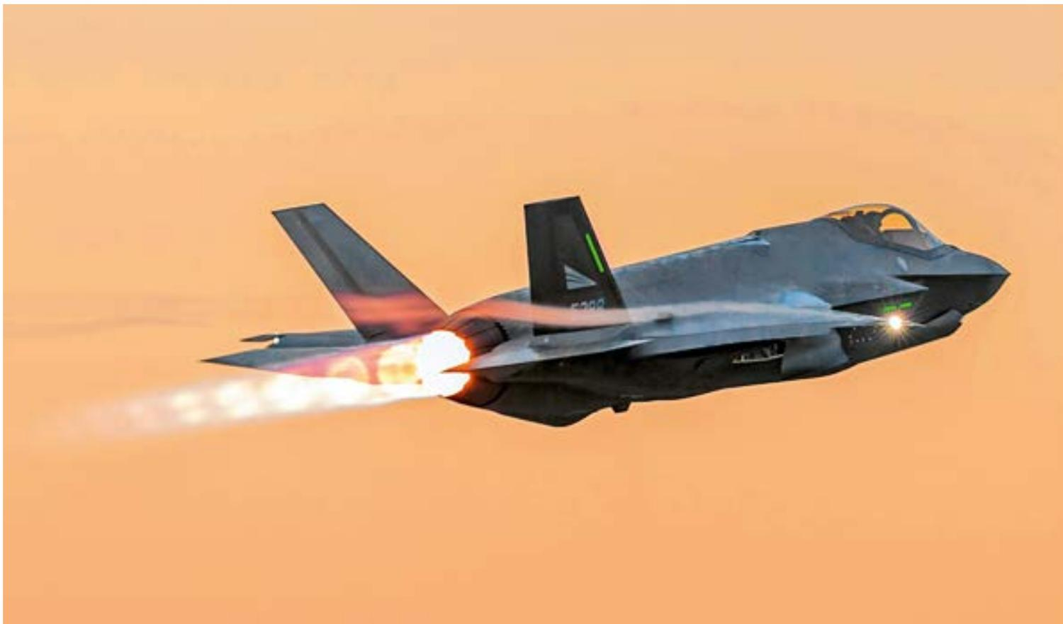
Der F-35 verfügt mit der gut 5,5 Meter langen F-135 Turbine über das stärkste Nachbrennertriebwerk der Welt. Aber der gestiegene Bedarf an Leistung und noch mehr Power.
