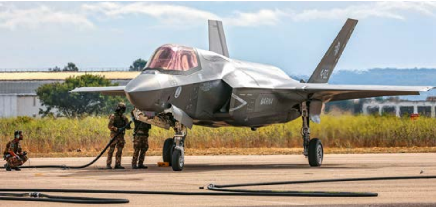
Die F-35B wurden in Alghero auf Sardinien im «Hot Pit»-Verfahren betankt, also bei laufenden Triebwerken.
