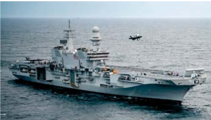
Der italienische Flugzeugträger Cavour mit seinem 220 Meter langen Flugdeck soll 2024 die Einsatzbereitschaft mit F-35B erlangen, welche die bisher eingesetzten AV-8B Harrier II ersetzen.
