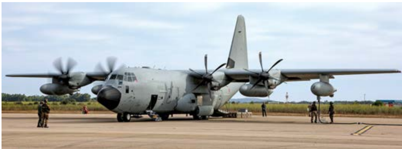
Die als Tankstelle für die F-35 dienende KC-130J Hercules der Aeronautica Militare. Der Treibstoff wird über den Pod am Flügel gepumpt, der auch für die Luft-Luft-Betankung zum Einsatz kommen kann.
