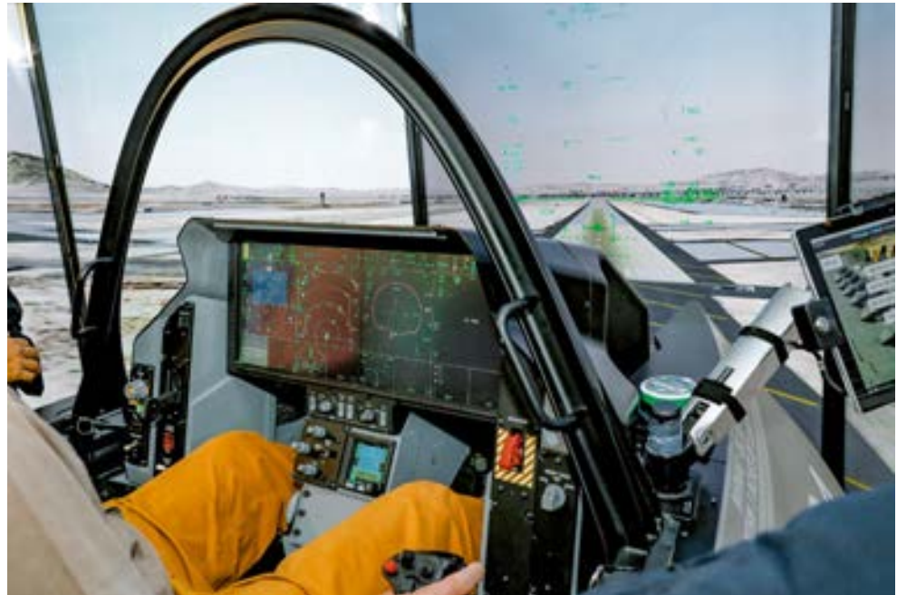
Es gibt im F-35-Cockpit kaum Triebwerksinstrumente, dominierend ist die Situationsdarstellung. Akustische und farbcodierte Warnungen würden über Abnormalitäten beim Triebwerk informieren und der Pilot könnte die entsprechenden Menu-Seiten aufrufen. Foto Eugen Bürgler
