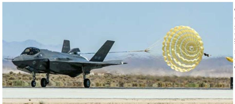
Die Schweizer F-35A sollen mit einem Bremsschirm ausgerüstet werden. Hier wird das Bremsschirmsystem mit einer F-35A der US Air Force auf der Edwards Air Force Base getestet.
