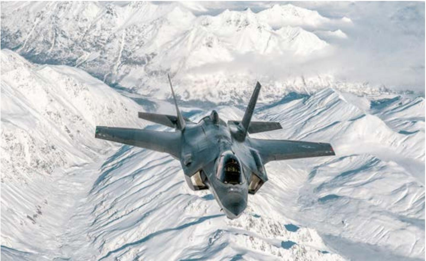
Hier eine F-35A mit dem Gehäuse für den Bremsschirm über dem Triebwerk, wie er für die Schweizer F-35A vorgesehen ist.
