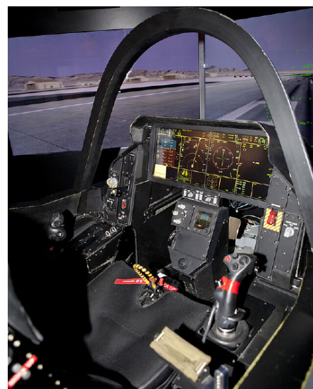
Beim Hersteller in Texas steht dieser Flug-Simulator mit originalgetreuem Cockpit.
