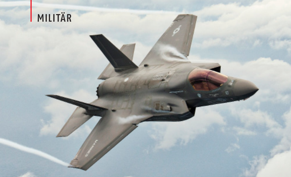
Das U.S. Marine Corps fliegt den Senkrechtstarter F-35B mit einem Hubtriebwerk hinter dem Cockpit.
