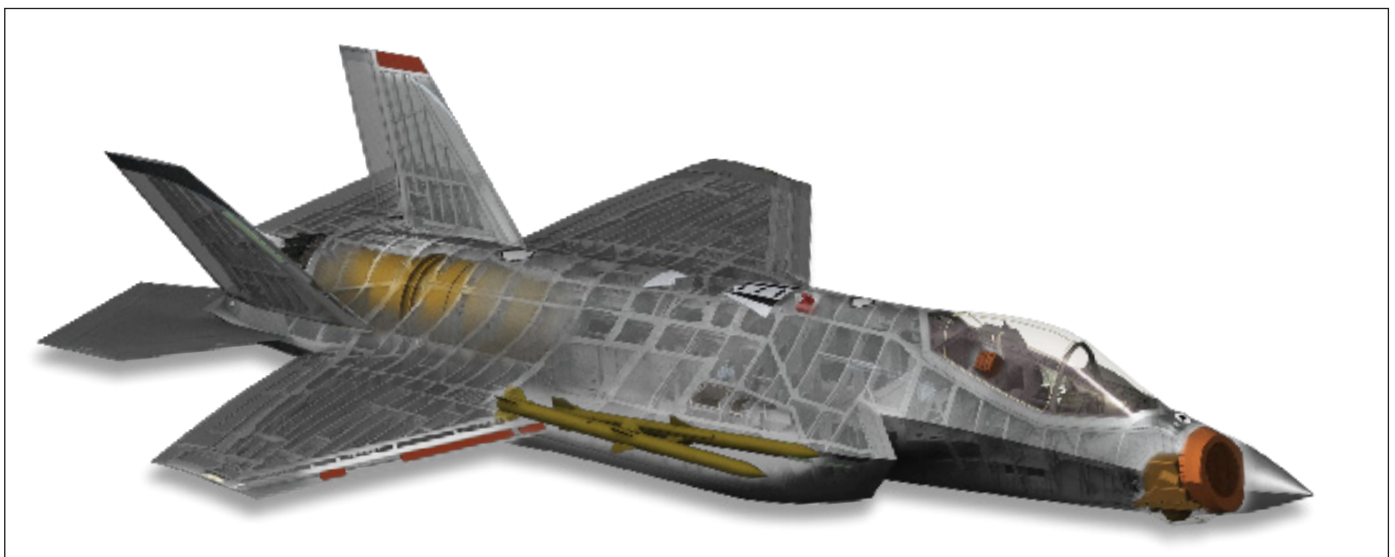
Innerer Aufbau der Lockheed Martin F-35A. Im internen Waffenschacht auf der Steuerbordseite trägt die Maschine zwei Luft-Luft-Raketen.
