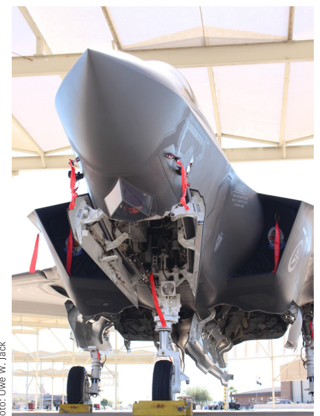
Unter dem Bug der Maschine befinden sich eine empfindliche Videokamera und ein Laser.
